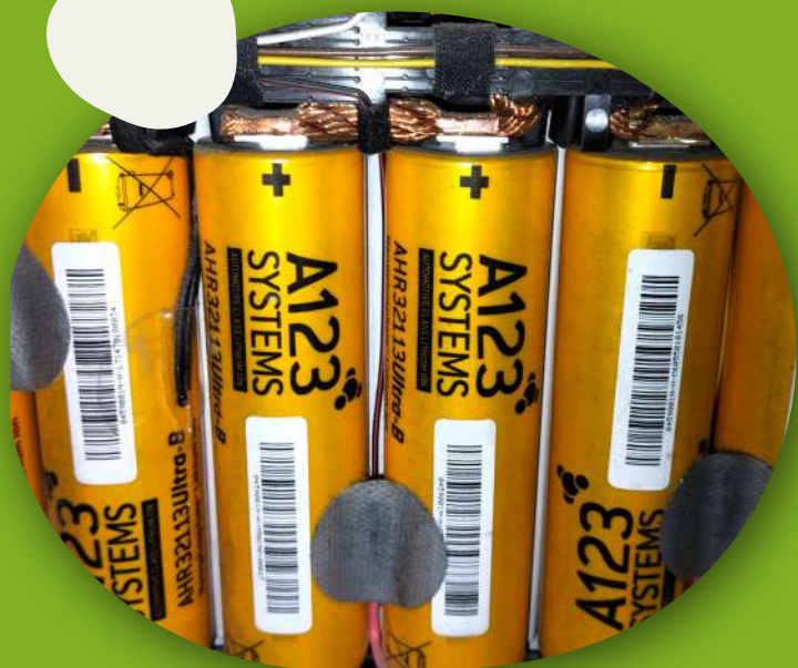
Ilustración 4. Empaquetamiento de geometría cilíndrica. Fuente: Recobatt S. A. S.
