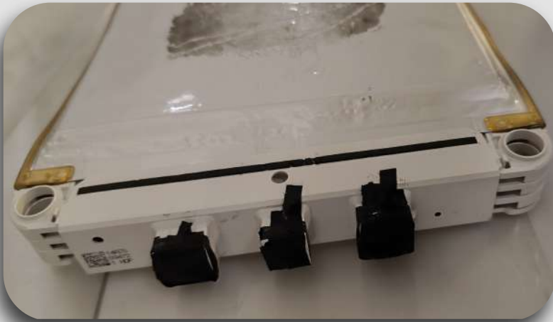
Ilustración 6. Ejemplo de aislamiento de los bornes para evitar el cortocircuito. Fuente: Recobatt S. A. S.
