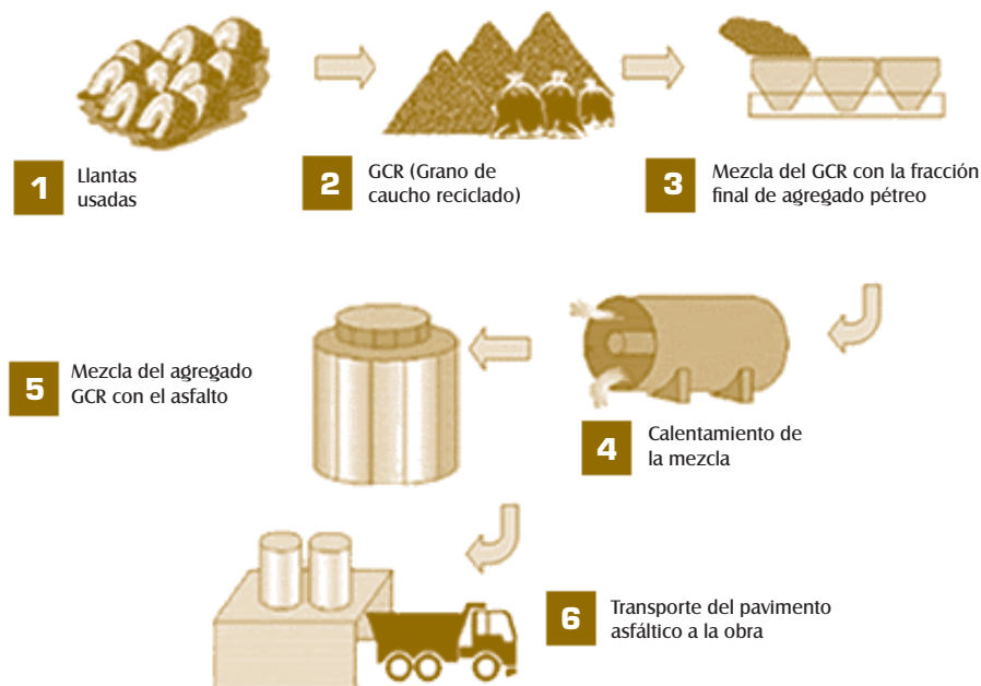
Proceso para la obtención de pavimento modificado convencional
